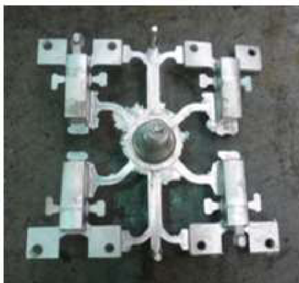
Obrázek č. 13: Produkt vzniklý na zinkovém lisu. Zdroj: Vlastní dokumentace z firmy Hettich ČR
