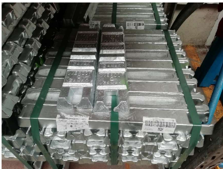
Obrázek č. 9: Surový zinek ve formě cihel. Zdroj: Vlastní dokumentace z firmy Hettich ČR
