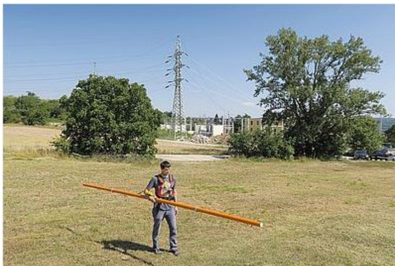
Obrázek 5 Přístroj CMD Explorer pro měření elektrické vodivosti půdy (gfinstruments.cz)
