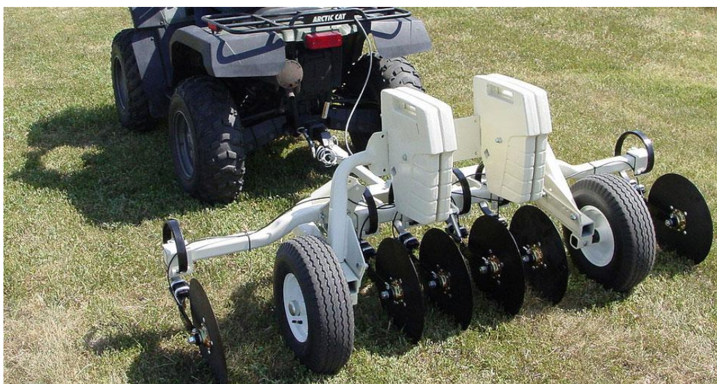
Obrázek 30 Mapování elektrické vodivosti půdy (veristech.com)
