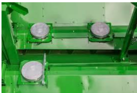
Obrázek 20 Tenzometrické váhy systému John Deere ActiveYield (ActiveYield, 2018)
