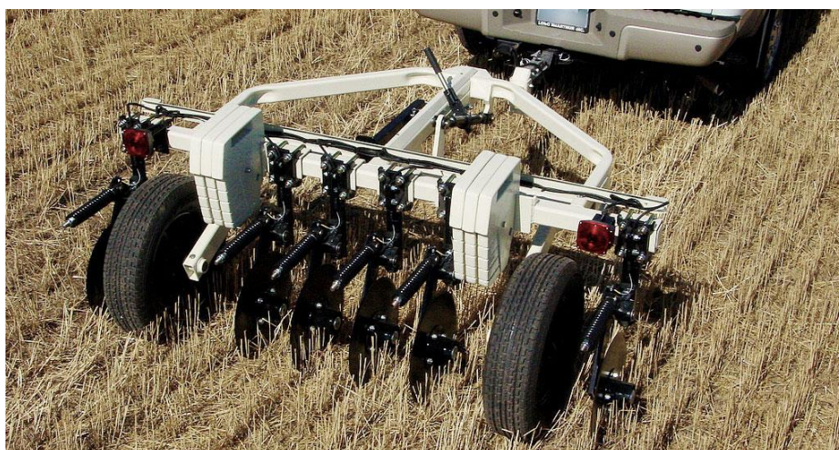
Obrázek 4 Přístroj pro měření elektrické vodivosti půdy Veris 3150 (veristech.com)
