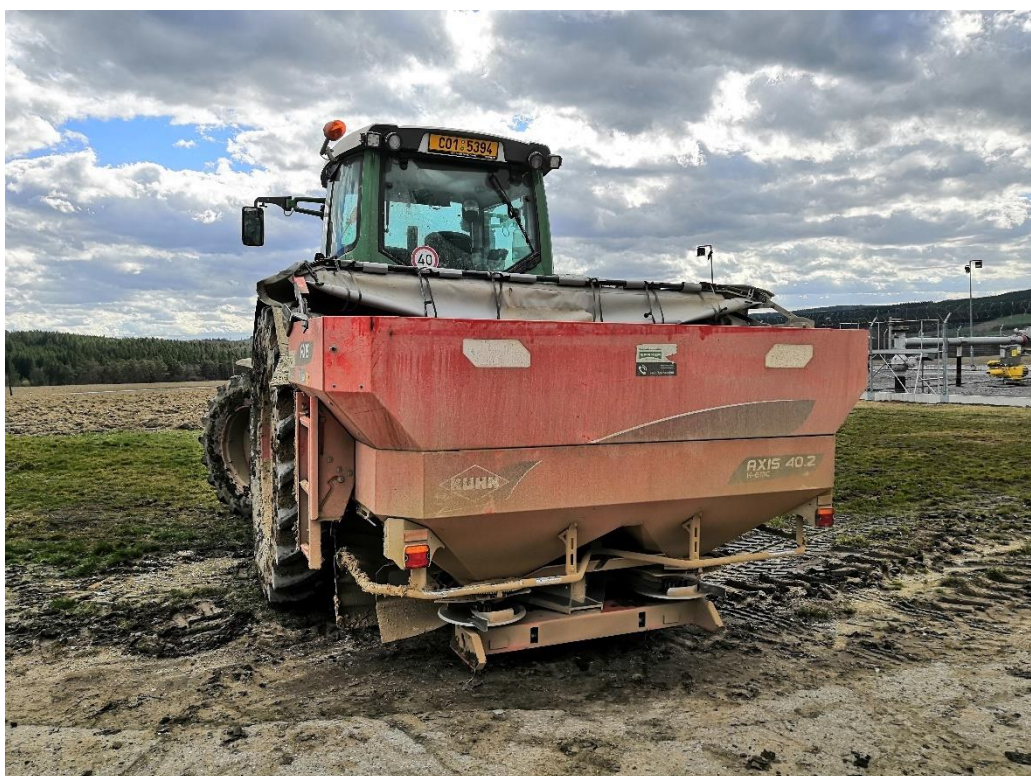
Obrázek 36 Rozmetadlo minerálních hnojiv s možností úpravy záběru (vlastní foto)
