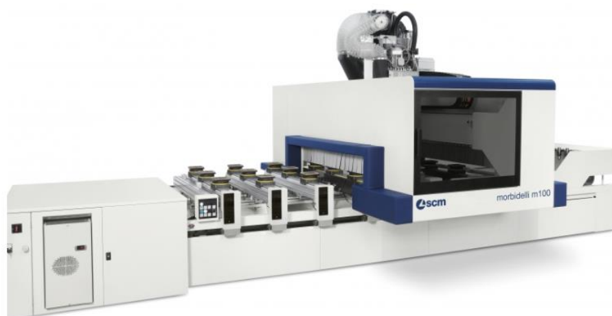
Obr. 2 Obráběcí centrum Morbidelli m100 od SCM (zdroj: Panas.cz [online]. [cit. 31.3.2024])
