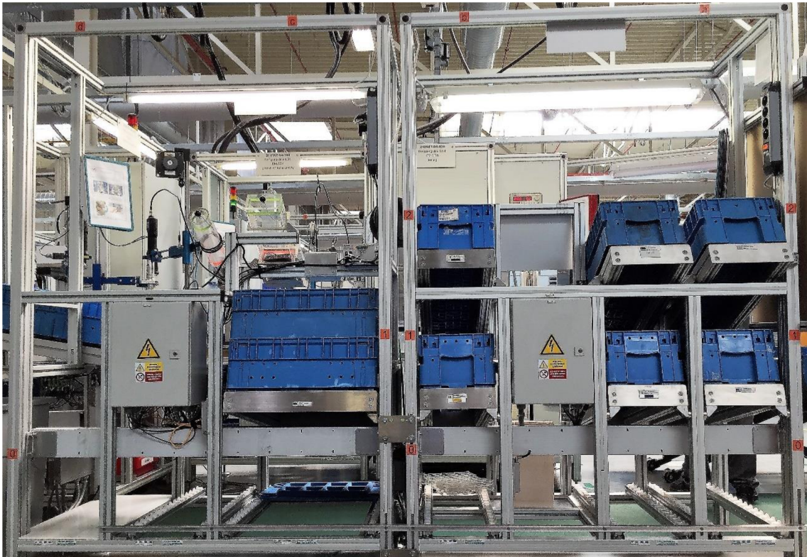
Obr. 5.3: Adresný systém výrobnéj linky. 75
