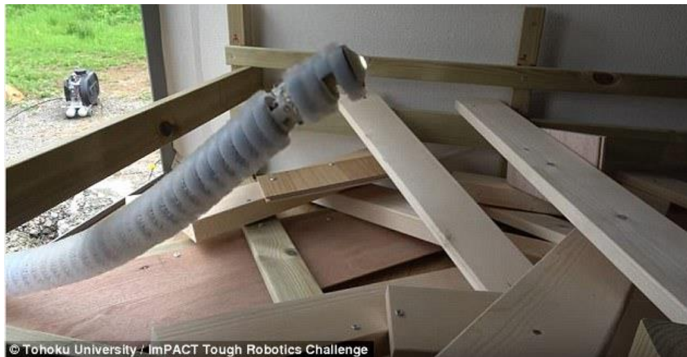
Obr. 14 Testování hada na japonské univerzitě [16]
