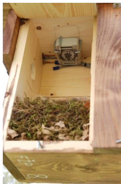
Obrázek 21. Chytrá ptačí budka – Interiér (autor: J. Králová), Vpravo je znázorněna technologická komora s řídicí jednotkou, vlevo hnízdní komora s kamerou.
