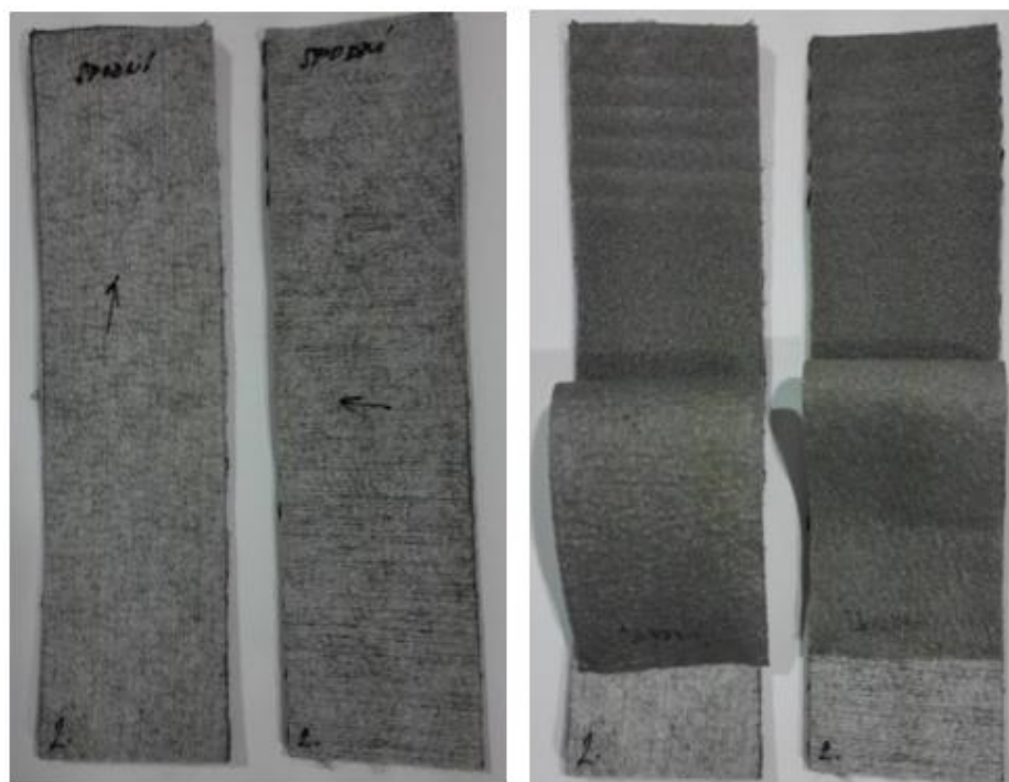
Obrázek č. 6 Vzorčky po zkoušce lpění vrstev, netkaná textilie od pěny
