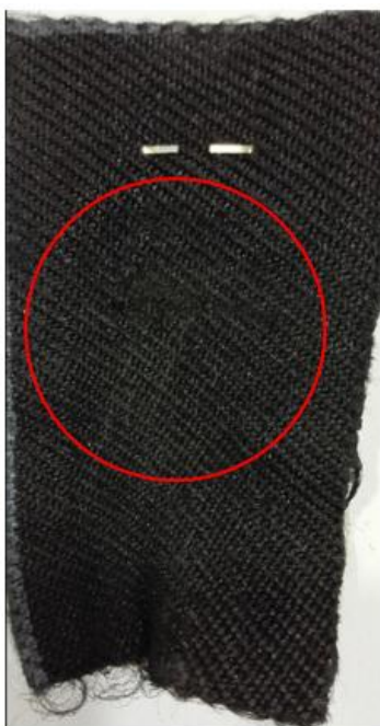
Obrázek č. 3 Vzorek bez plastovém nosiče po zkoušce Xenotest
