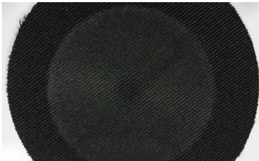
Obrázek č. 4 Vzorek po zkoušce opotřebení materiálu
