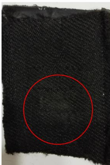
Obrázek č. 2 Vzorek na plastovém nosiči po zkoušce Xenotest
