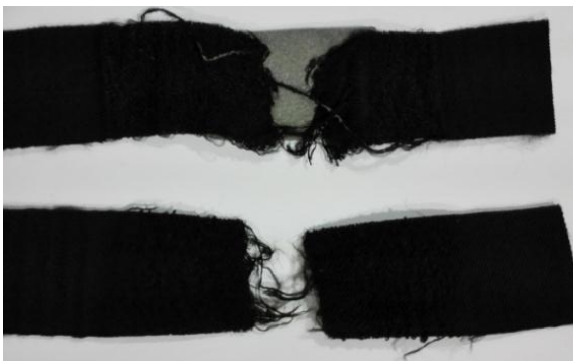
Obrázek č. 8 Vzorky po zkoušce tržné síly a dynamického protažení po osnově a útku
