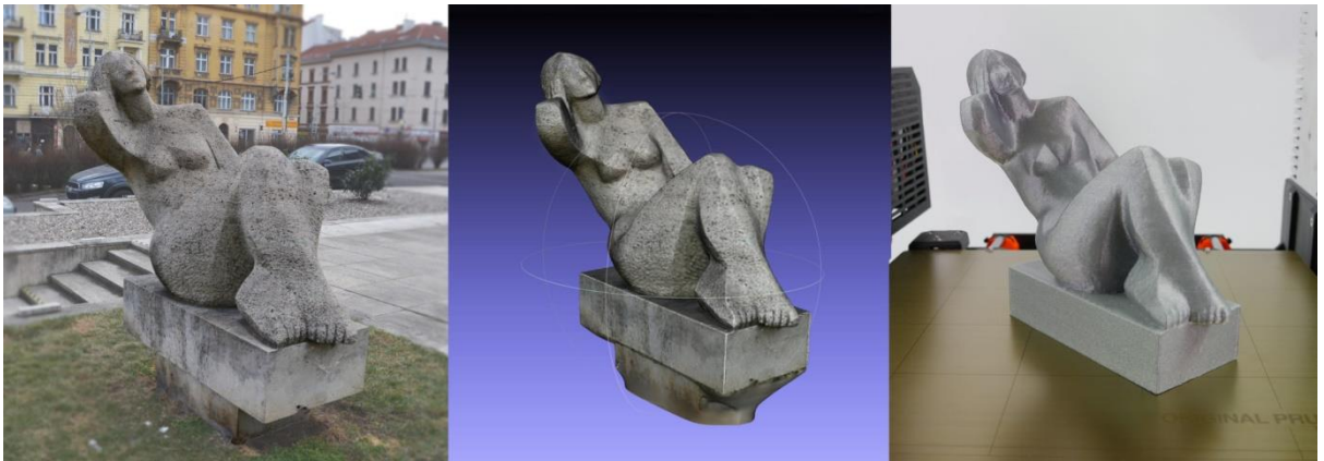
Obr. 15 – Příklad využití fotogrammetrie. Nalevo – Socha Sedící ženy Václava Bejčka, 1967. Uprostřed - naskenovaný 3D model. Napravo – Rekonstrukce sochy využitím 3D tisku. 19
