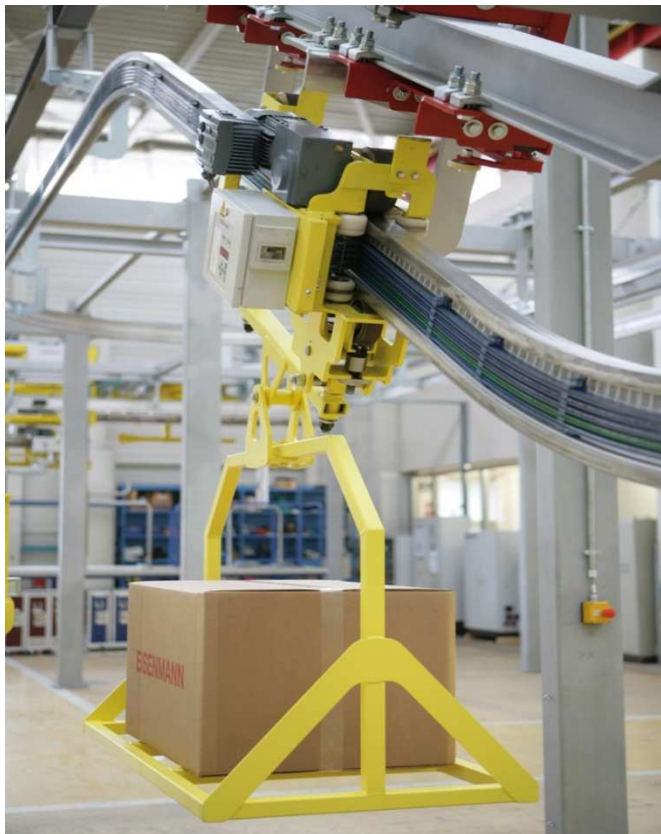
Obr. 2 Monorail dopravník „lehký“ firmy Eisenmann [13]
