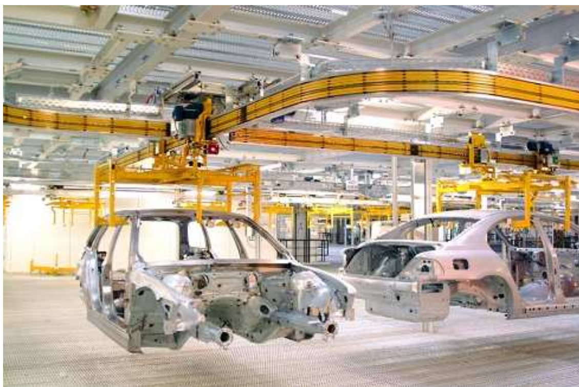
Obr. 1 Elektrický monorail dopravník pro přenos automobilní karoserie [26]
