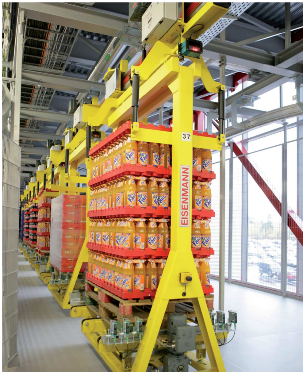
Obr. 3 Monorail dopravník „těžký“ Eisenmann [13]
