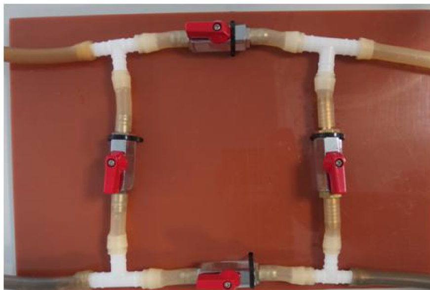
Obrázek 5: Zařízení pro změnu směru proudění ve výměníku
