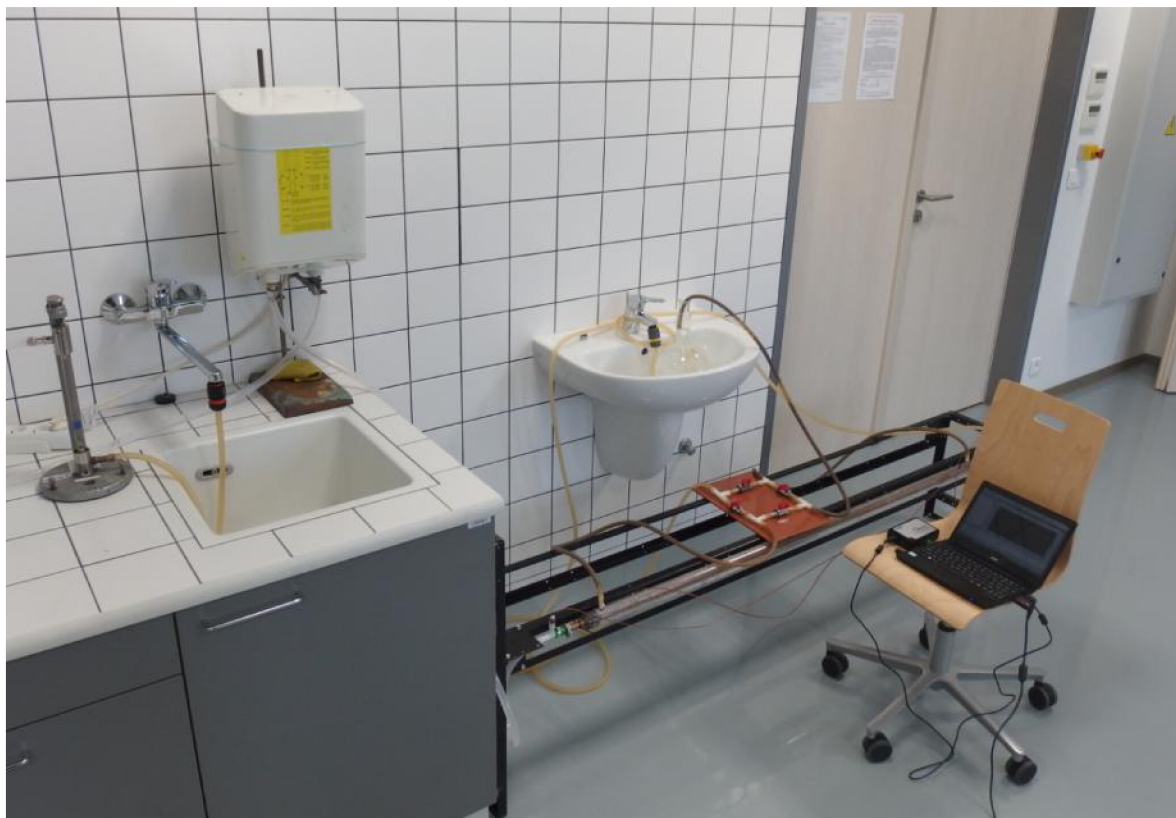
Obrázek 10: Měření parametrů tepelného výměníku
