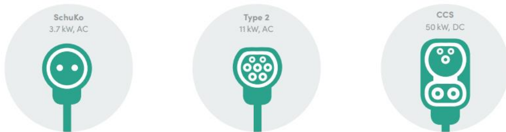
Obr. 20 Typy podporovaných zástrček pro elektromobil Sion [42]
