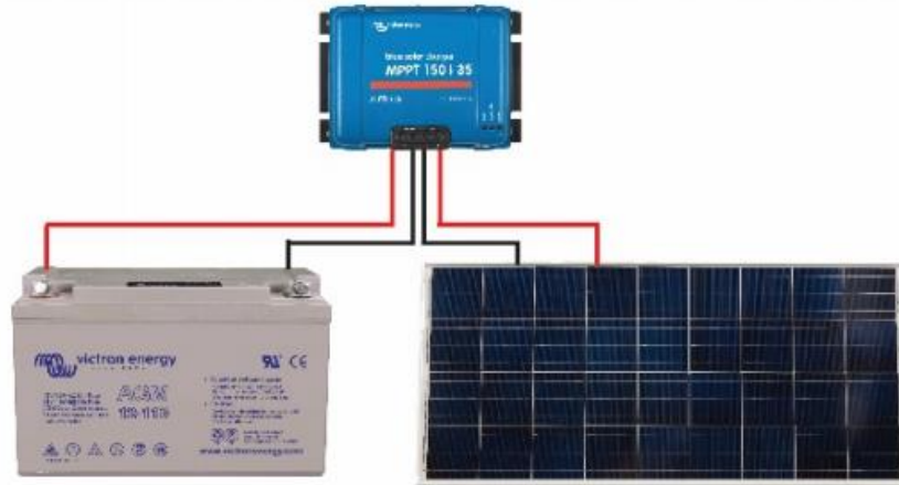
Obr. 34 Dvou vodičové zjednodušené schéma zapojení regulátoru SmartSolar MPPT 150/35 [77]
