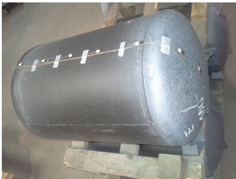
Obrázek 3 - Nalepení termočlánků na nádobu II
