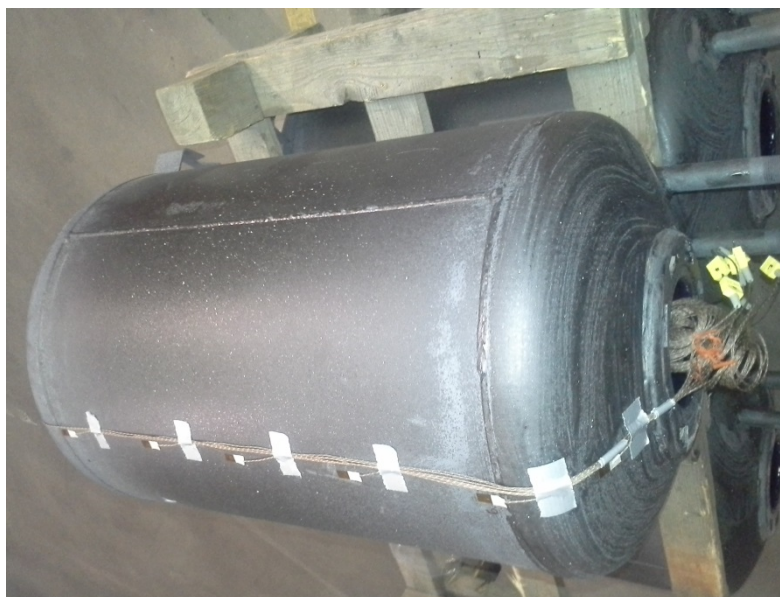
Obrázek 2 - Nalepení termočládků na nádobu I
