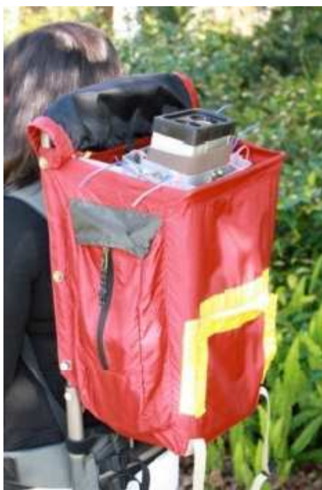
Obr. 6 Lidar v batohu na zádech (Listopad et al., 2011)
