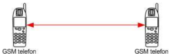
Obrázek 5.9: Full-duplex komunikace. Zdroj: [7]
