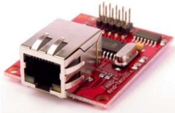
Obrázek 5.1: Ethernetový modul ENC28J60. Zdroj: [5]
