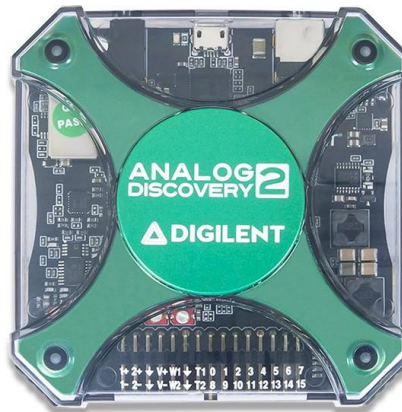
Obr. 5.6: Digitální USB osciloskop Analog Discovery 2.
