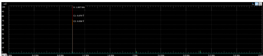
Obr. 6.13: Graf ramen interferometru při 1000 Hz a proudu 15 mA pomocí AD
