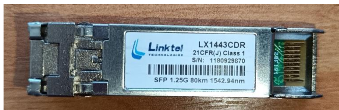
Obr. 3.16: SFP modul Linktel
