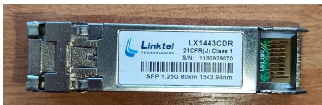
Obr. 3.16: SFP modul Linktel
