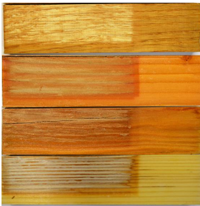
Příloha 1. Obr. 4 „8. stupeň odlupování (poškození do 90 % vystavené plochy“; DB, MD, SM, DG
