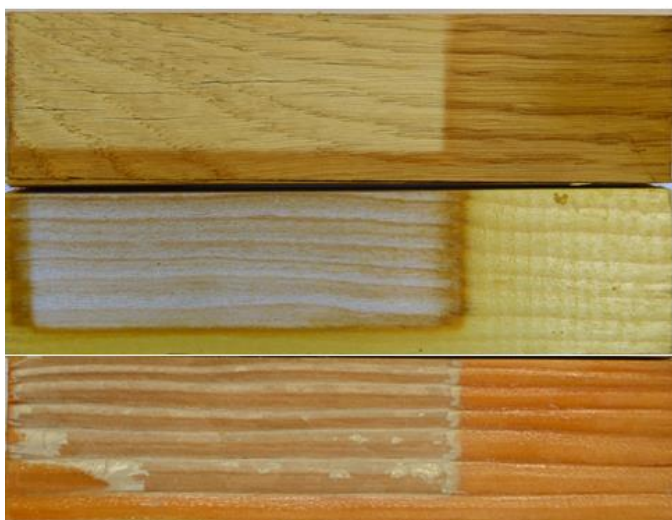
Příloha 1. Obr 5 «9. stupeň odlupování (poškození do 100% vystavené plochy)»; DB, SM, DG
