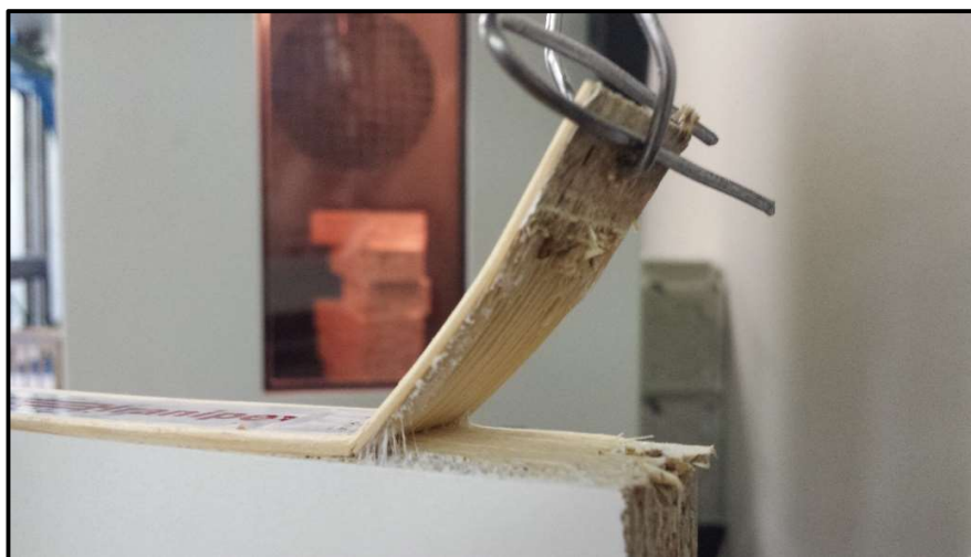
Obr. 28 Detail průběhu odlupování vzorku PUR lepidla při působení teploty 60 °C
