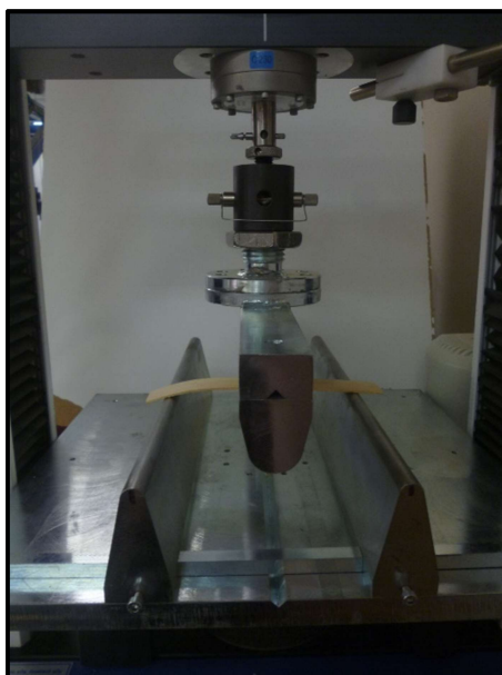
Obr. 9 Zkušební agregát pro zkoušku odolnosti dýchové pásky v ohybu
