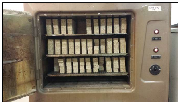
Obr. 6 Sušárna řady STE se vzorky pro zkoušku odolnosti v šikmém tlakovém smyku pod úhlem 45^\circ
