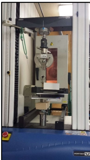
Obr. 7 Zkušební agregát pro zkoušku odolnosti v odlupování pod úhlem 90°
