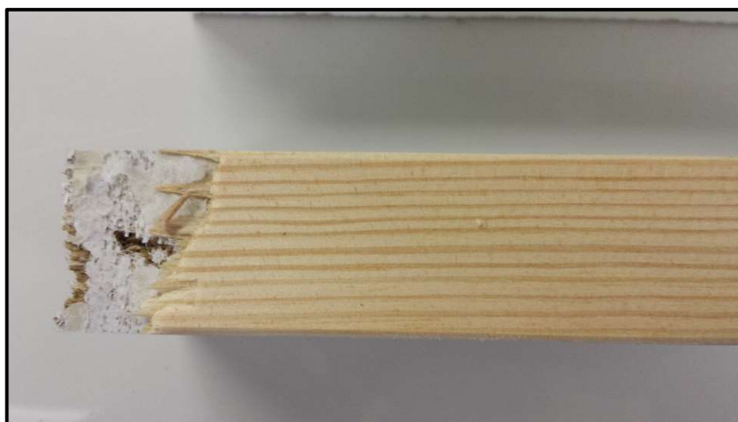
Obr. 30 Detailní pohled na povrch odloupnuté dýhové pásky za použití PUR lepidla při působení teploty 60 °C
