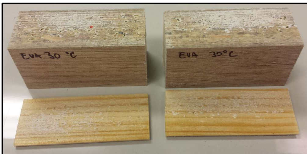
Obr. 34 Detailní pohled na povrch odtržené dýhy za použití EVA lepidla při působení teploty 30 °C
