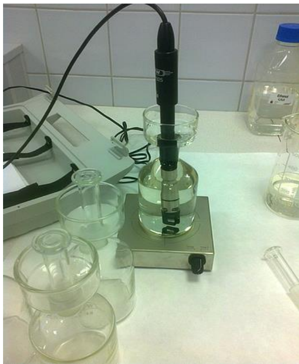
Obrázek č. 1: Stanovení biochemické spotřeby kyslíku (Burianová, 2014)
