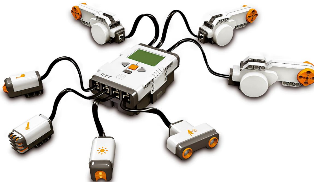
Obrázek 1.1: NXT brick se třemi servomotory, dotykovým, zvukovým a světelným senzorem a ultrazvuk (převzato z [37])
