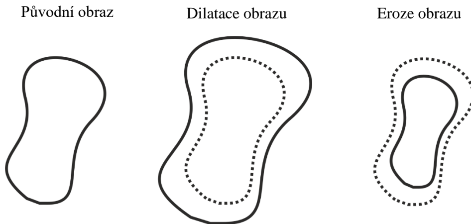
Obrázek 3.10: Porovnání operací dilatace a eroze (podle [16])
