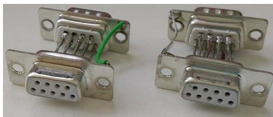
Obrázek 10: Propojky konektorů umožňující odposlech (vlevo) a s propojenými piny (vpravo).
