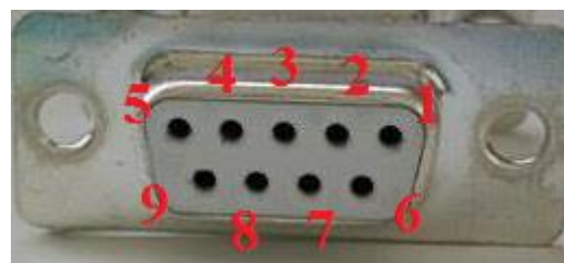
Obrázek 9: Umístění pinů u konektoru typu samec (vlevo) a samice (vpravo).
