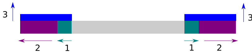
Obrázek 4.2: Modelování segmentu solidní mostovky: Šedá je původní kvádr, tyrkysová část vzniká první operací extrude, fialová opakováním této operace a tmavě modrá třetí operací.
