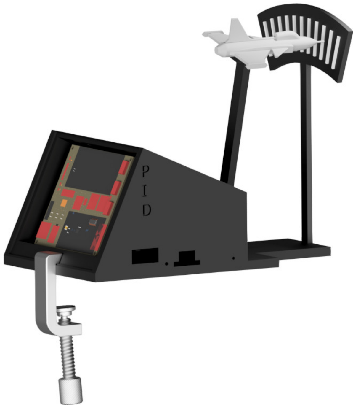
Obrázek 1.1: Sestava pro demonstraci PID
