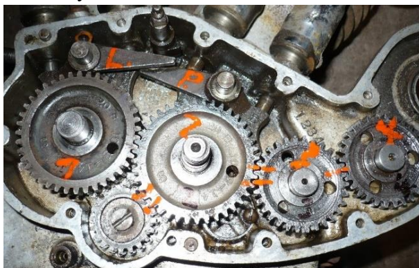
Obrázek 32 Rozvody spalovacího motoru
