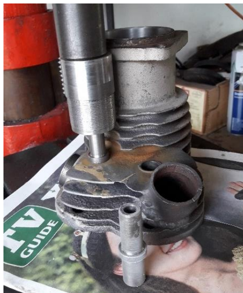
Obrázek 37 Lisování vodítek ventilů
