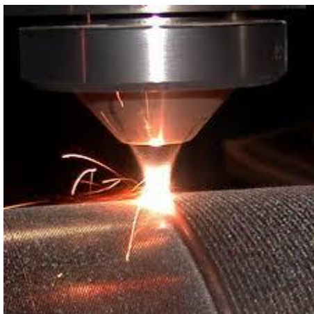
Obrázek 7 Aplikace navařování laserem [21]
