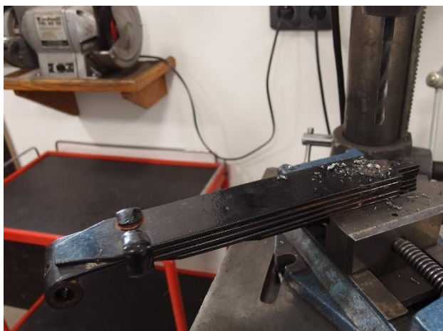
Obrázek 55 Vrtání otvorů listové pružiny na opravný rozměr
