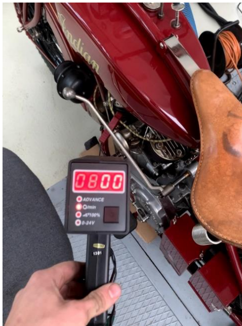
Obrázek 67 Měření otáček v režimu 800 ot/min
