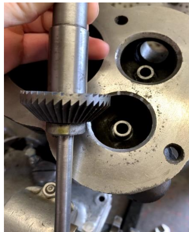
Obrázek 39 Frézovací hlavice sedel ventilů
