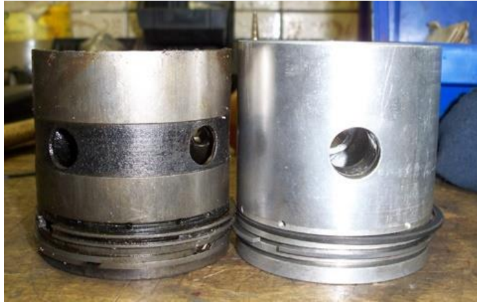
Obrázek 42 Nový píst vyrobený dle předlohy (před jeho zkrácením)
