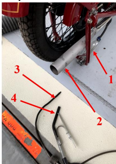
Obrázek 68 Redukce koncovky výfuku a odběrové sondy analyzátorů
