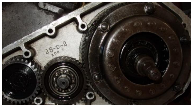
Obrázek 30 Primární převod po očištění
