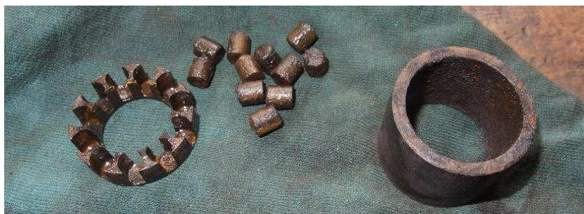
Obrázek 41 Válečkové ložisko s jednostranně uzavřenou klecí
