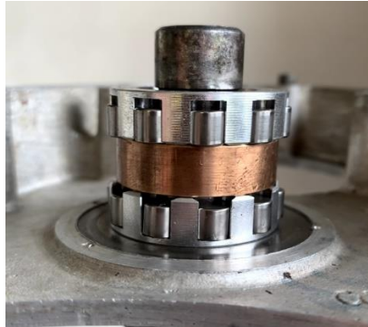
Obrázek 48 Nové uložení středového kola primárního převodu
