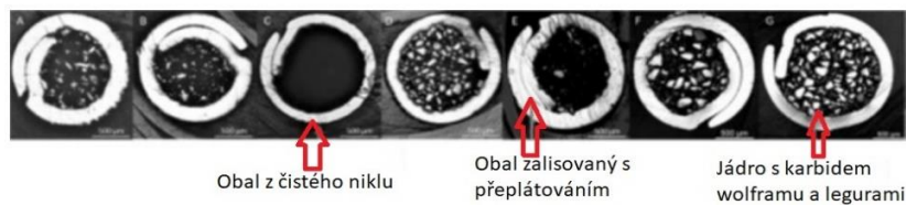
Obrázek 8 Různé průřezy a druhy plněných elektrod
