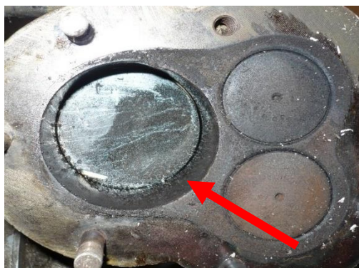
Obrázek 35 Aplikace neoriginálních vložek válců
