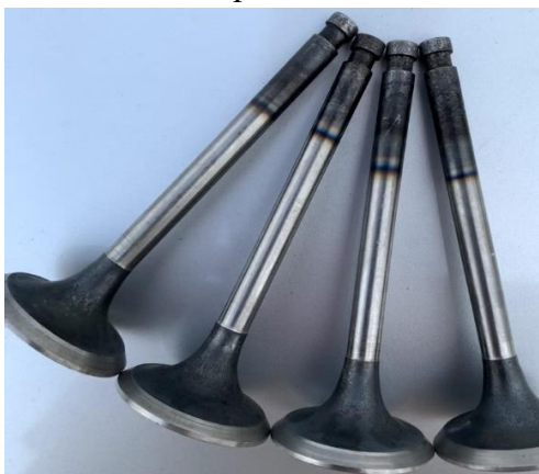
Obrázek 38 Nově sací a výfukové ventily po zkrácení a tepelném zpracování
