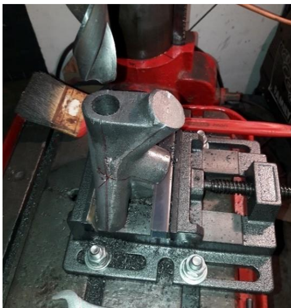
Obrázek 52 Vrtání podsedadlového odlitku
