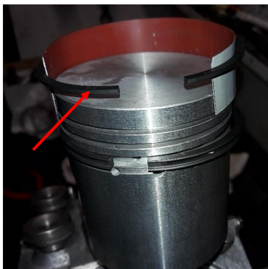
Obrázek 59 Montáž pístních kroužků
