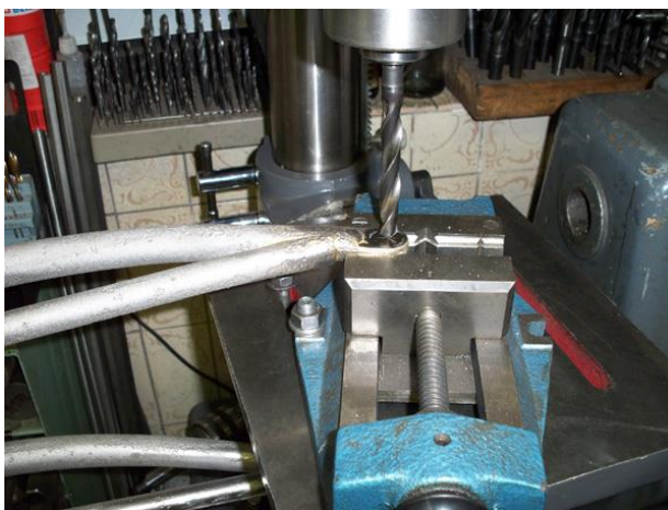
Obrázek 54 Renovace otvorů vidlice na původní rozměr
