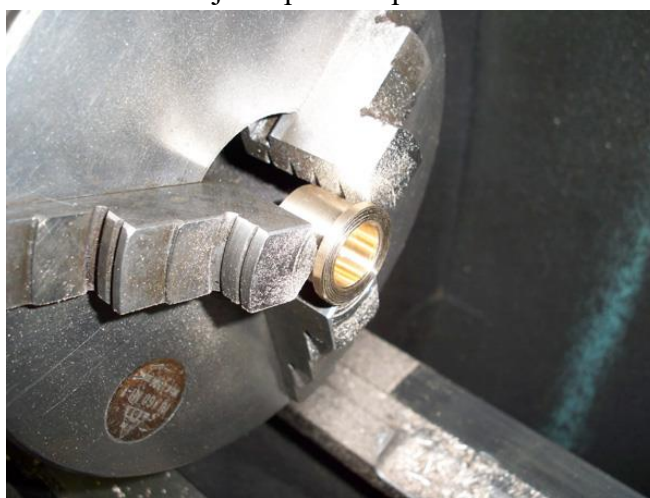
Obrázek 45 Soustružení kluzných ložisek rozvodových kol
