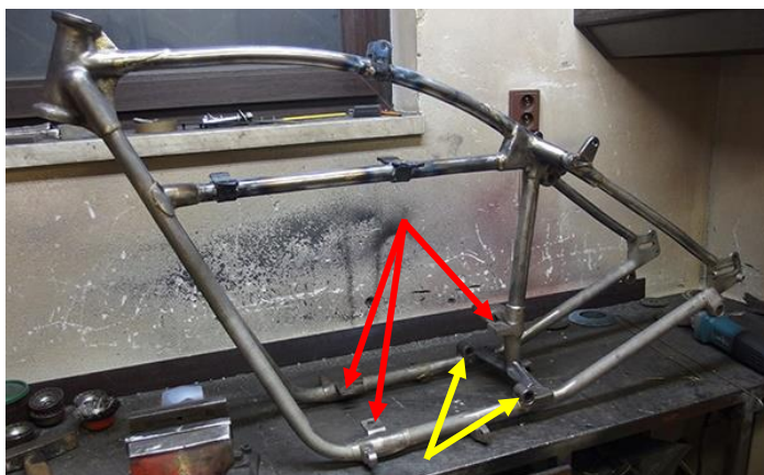
Obrázek 53 Nosný rám po opravě horní části
