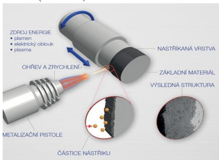
Obrázek 10 Princip žárového nástřiku [28]
