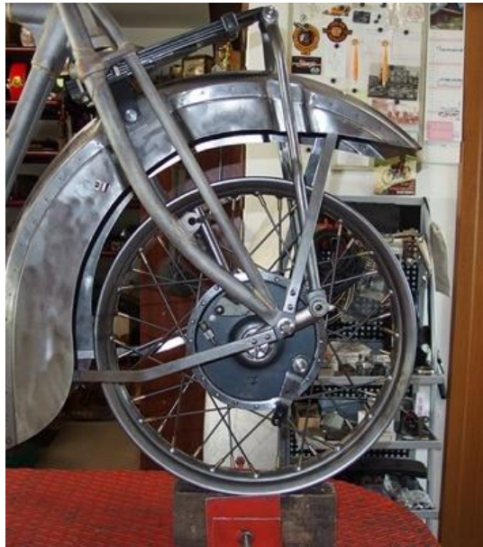
Obrázek 56 Pasování předního blatníku s novými vzpěrami
