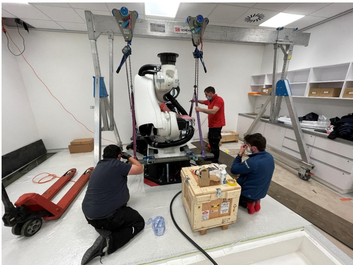
Obrázek 14 - Ukotvení přístroje do podlahy, zdroj: Oberstein
