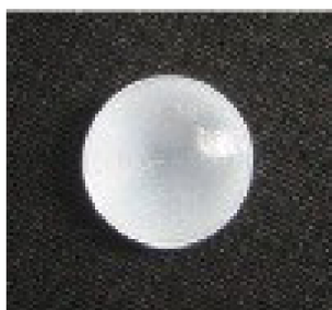
Obrázek 20: IR čočka HW, [11]
