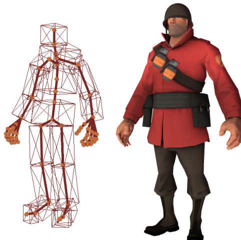
Obrázek 2.18: Model postavy a jeho fyzikální reprezentace v podobě soustavy tuhých těles
