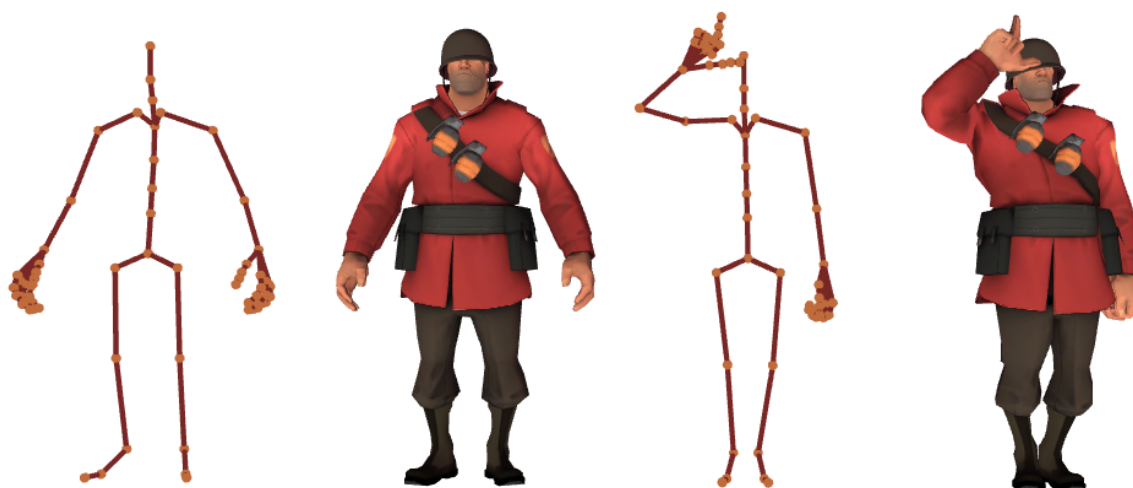
Obrázek 2.6: Princip animace pomocí kosterního systému
