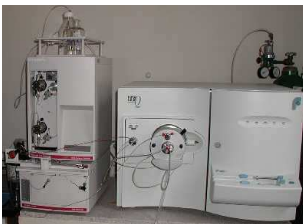
Obrázek 2: Spojení kapalinového chromatografu Beckmann a hmotnostního spektrometru Thermo Finnigan. (Katedra Analytické chemie, Univerzita Palackého, Olomouc)
