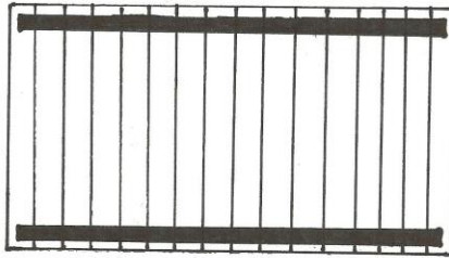
Obrázek č. 14: Půdorys desky s podélnými prkny a příčnými svlaky a desky s příčnými prkny a podélnými svlaky.
