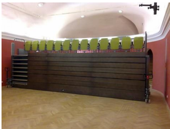
Obrázek č. 11: Složená teleskopická elevace v loutkovém divadle v Třeboni
