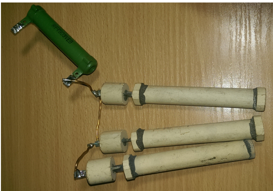
Obrázek č. 29: Použité zatěžovací rezistory o celkovém odporu 1300 \Omega .
