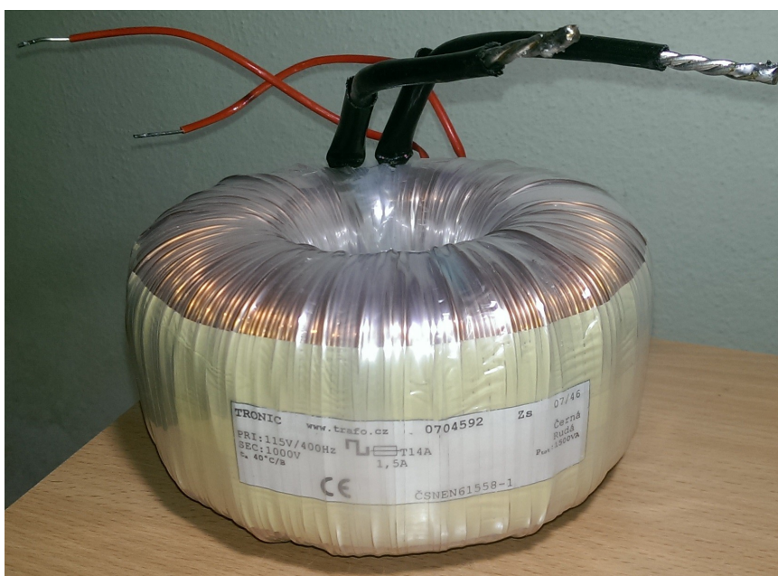
Obrázek č. 30: Použitý transformátor.
