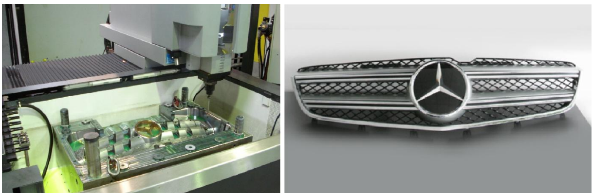
Obr. 1.32 Přední mřížka vozu značky Mercedes vyrobena firmou MAIER s pomocí hloubičky ONA QX6 [29].
