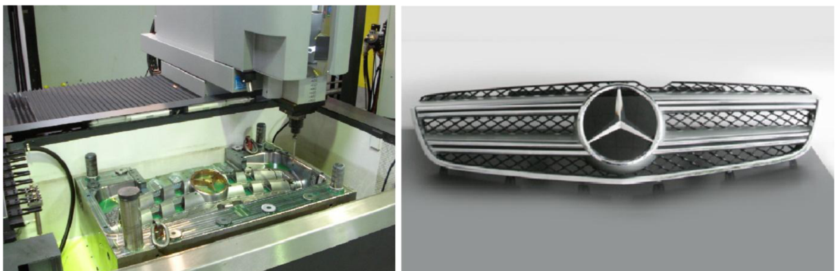
Obr. 1.32 Přední mřížka vozu značky Mercedes vyrobená firmou MAIER s pomocí hloubičky ONA QX6 [29].
