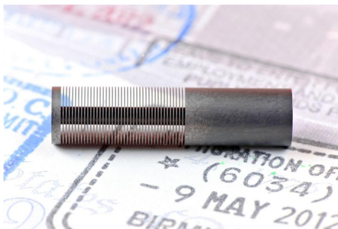
Obr. 1.25 Žebrová elektroda z grafitu [19].
