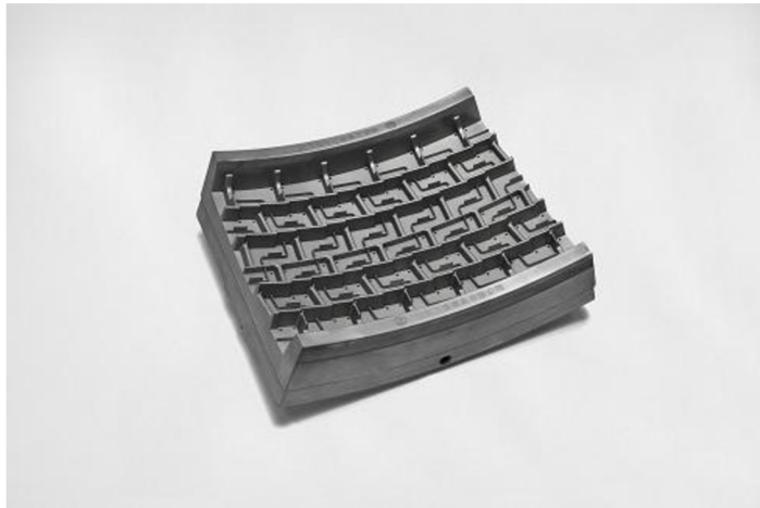
Obr. 1.31 Forma pro výrobu pneumatik [25].
