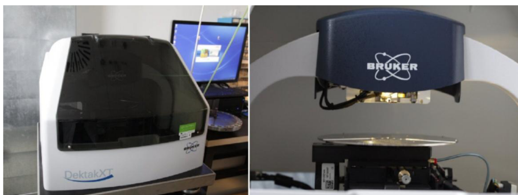
Obr. 3.1 3D kontaktní profilometr Dektak XT [38].
