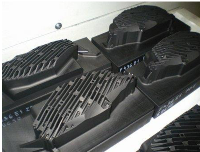
Obr. 1.24 Ukázka tvarové elektrody z grafitu [18].
