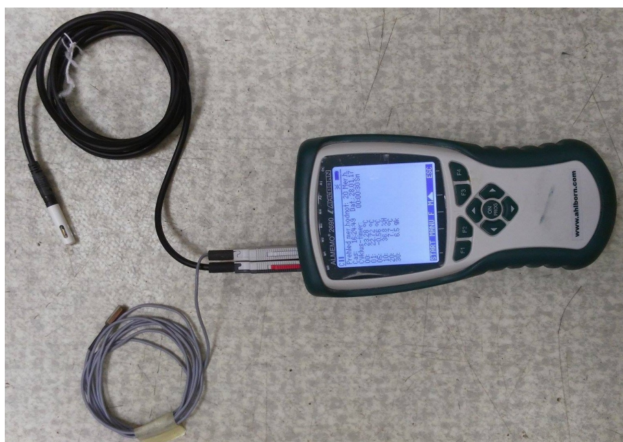
Obr. 4 Vyobrazení použité teplotní ústředny Ahlborn s čidly
