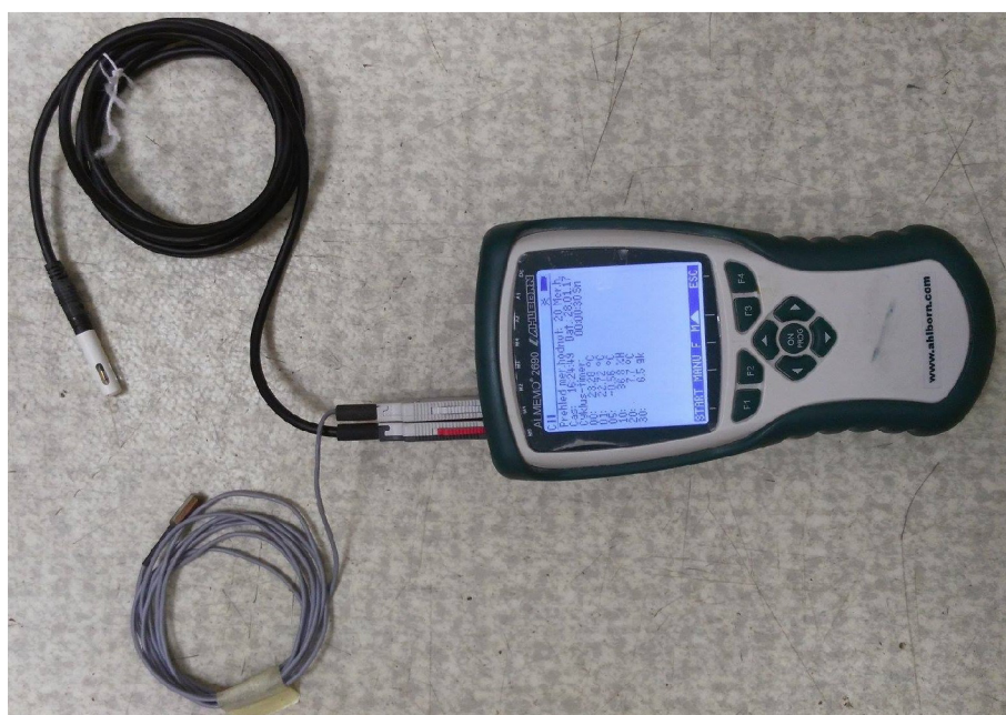
Obr. 4 Vyobrazení použité teplotní ústředny Ahlborn s čidly
