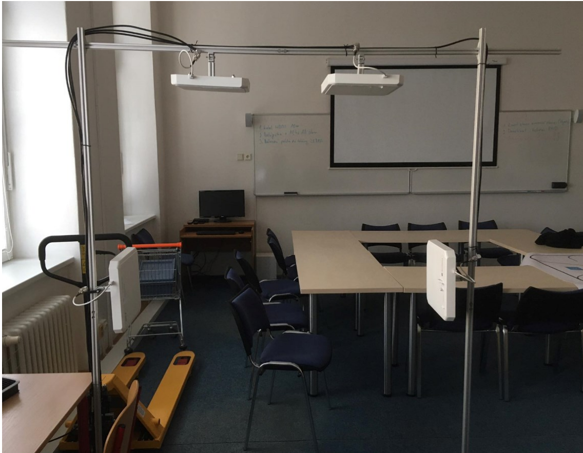
Obr. 3.4 Rozmístění antén na bráně
