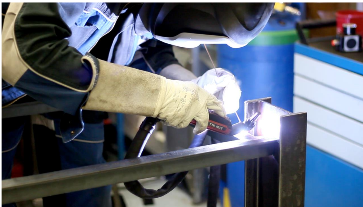
Obr. 65: Svařování nosné konstrukce k nohám stolu
