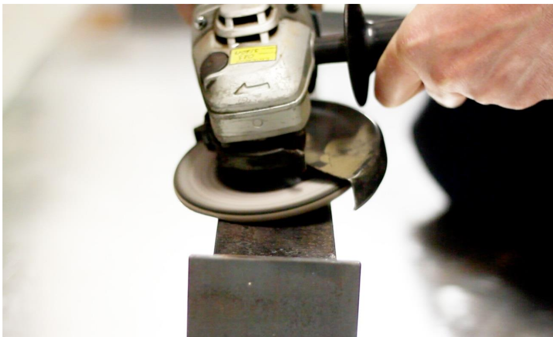
Obr. 78: Broušení bočních ploch I profilu
