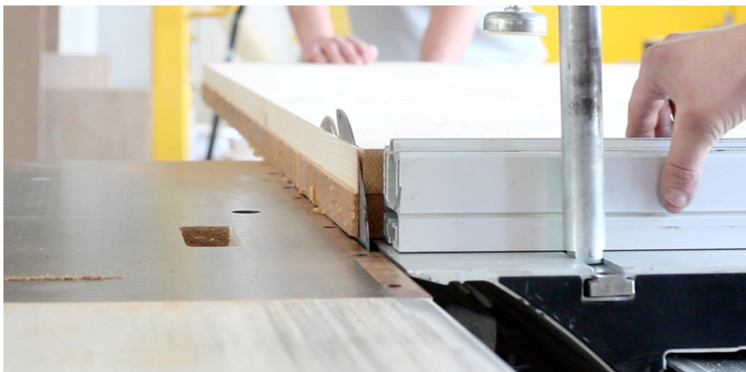
Obr. 72: Formátování stolové desky
