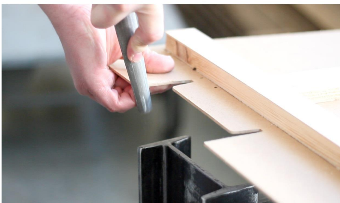
Obr. 73: Dobroušení šablony pro osazení I profilu
