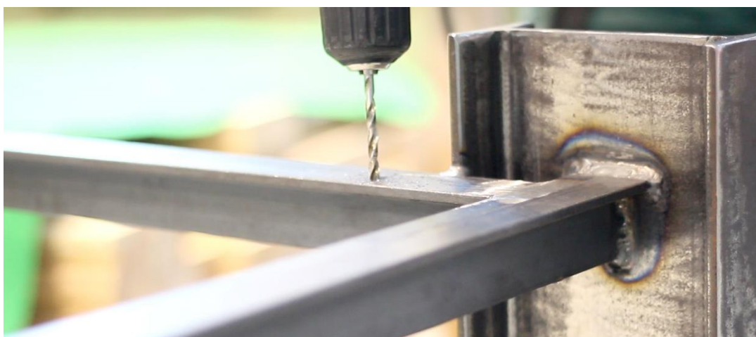
Obr. 64: Vrtání otvorů pro uchycení stolové desky
