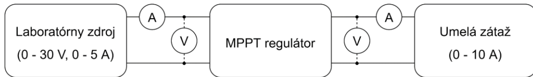
Obr. 6-2: Zapojenie prístrojov pri meraní účinnosti
