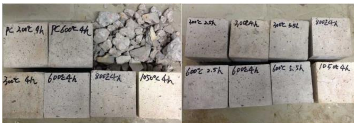
Obrázek 33: Betonové vzorky po teplotním zatížení pro různé teploty a doby výdrže [43]
