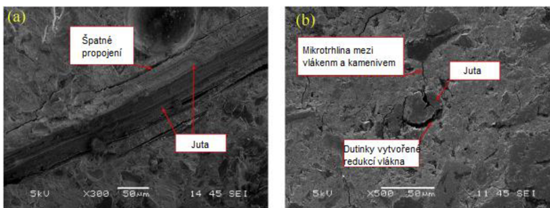
Obrázek 30: Jutové vlákno v betonu a) při pokojové teplotě a b) při teplotě 200 °C [42]
