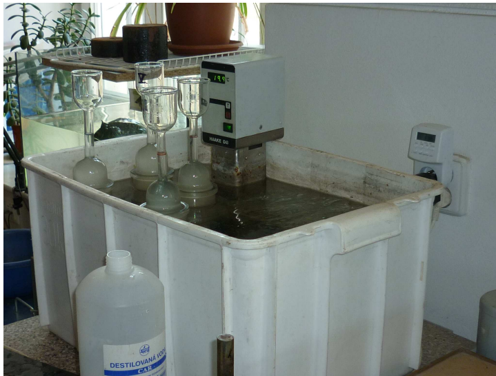
Obr. 17: Pycnometry penetrovány ve vodní lázni
