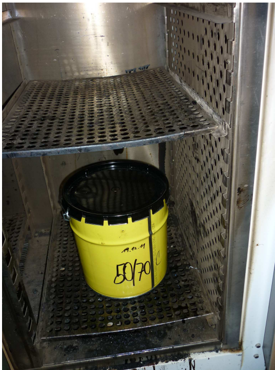
Obr. 34: Rozehřátí asfaltového pojiva
