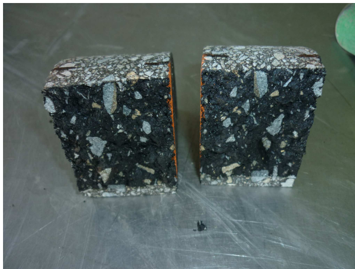
Obr. 60: – Rozlomené půlválcové těleso – rozlomené kamenivo
