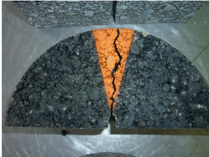
Obr. 59: – Průběh trhliny po provedené zkoušce u AC 11 DS
