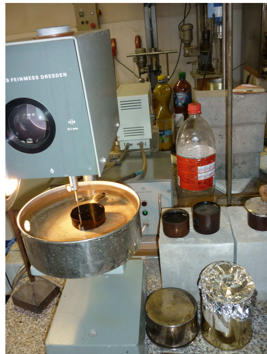
Obr. 23: Temperování asfaltového pojiva
