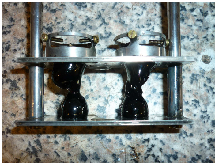
Obr. 29: Protážení asfaltového pojiva – úspěšně provedená zkouška
