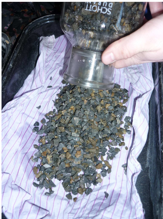
Obr. 18: Povrchové osušení kameniva
