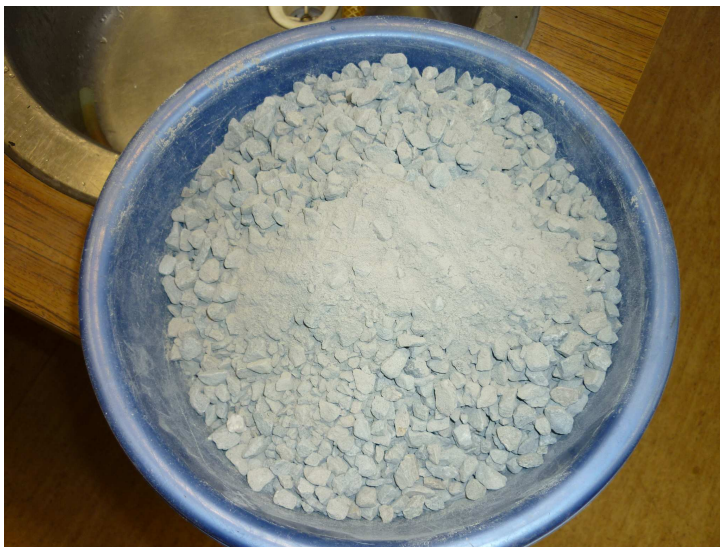
Obr. 13: Částečně podrcené kamenivo po provedené zkoušce
