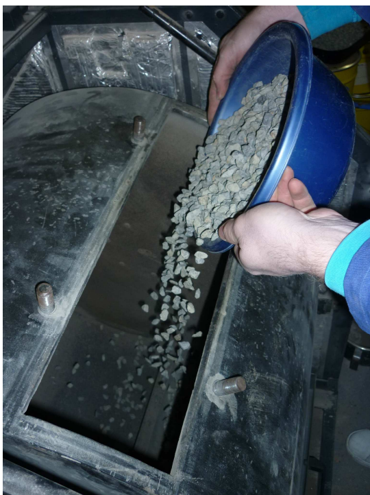
Obr. 9: Vsypaní kameniva do bubnu
