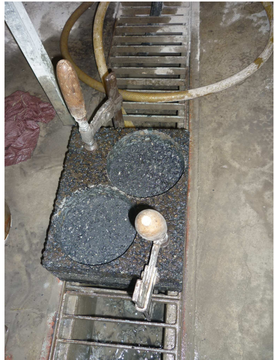
Obr. 65: Deska po jádrových vývrtech
