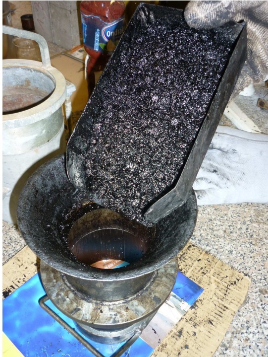
Obr. 42: Vsypaní asfaltové směsi do pěchu Obr. 43: Úprava asfaltové směsi v pěchu
