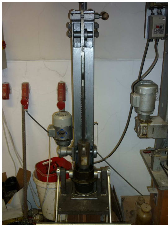
Obr. 42: Vsypaní asfaltové směsi do pěchu Obr. 43: Úprava asfaltové směsi v pěchu
