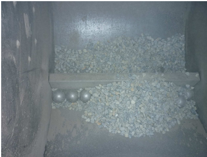
Obr. 11: Kamenivo a ocelové koule v otloukacím bubnu
