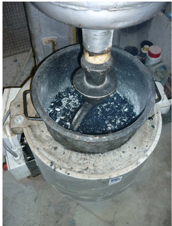
Obr. 37: Míchání asfaltové směs
