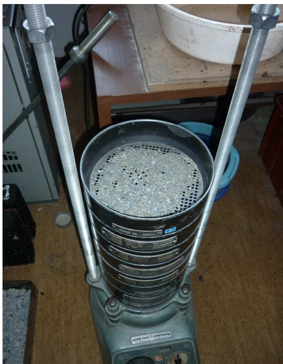
Obr.: 5: Sítový rozbor- sada sít na vibračním přístroji
