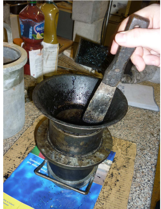
Obr. 42: Vsypaní asfaltové směsi do pěchu Obr. 43: Úprava asfaltové směsi v pěchu
