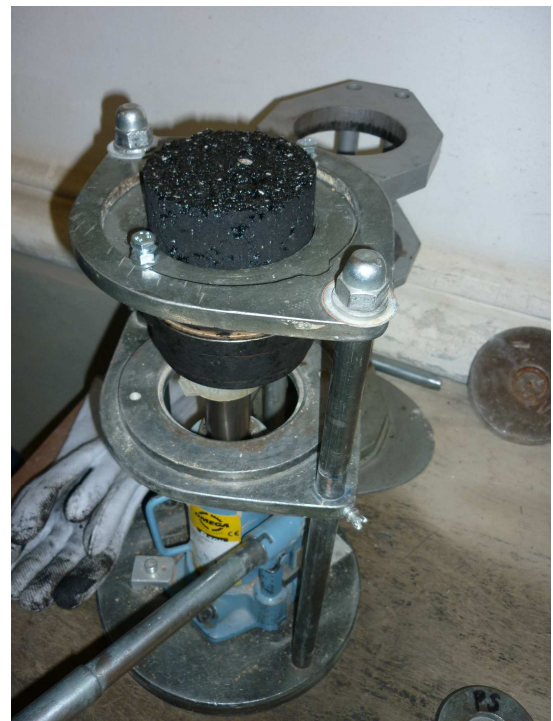
Obr. 42: Vsypaní asfaltové směsi do pěchu Obr. 43: Úprava asfaltové směsi v pěchu
