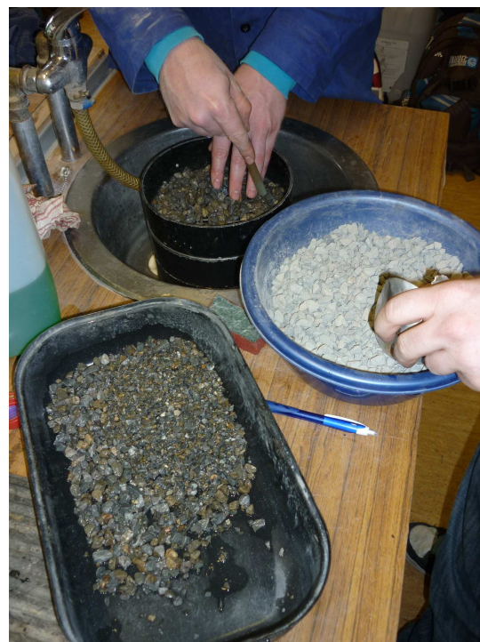
Obr. 10: Promývání kameniva na síti 1,6 mm
