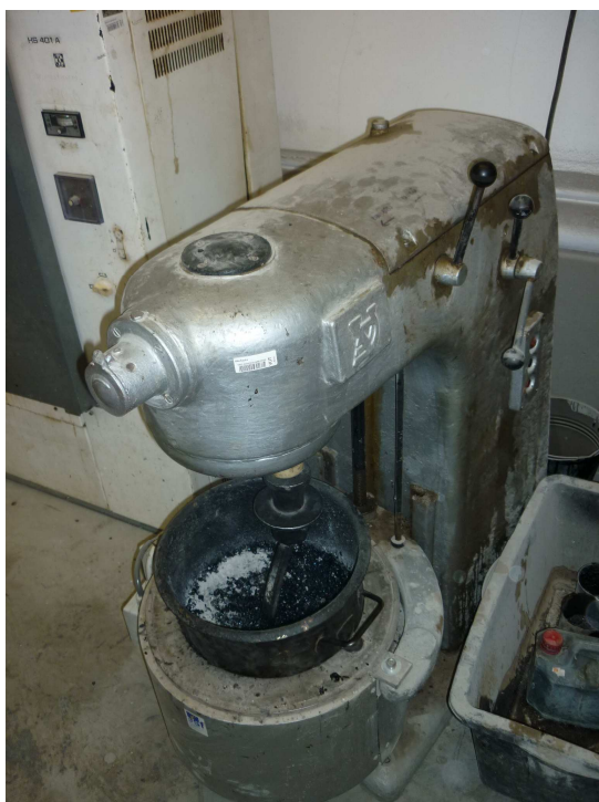
Obr. 38: Míchání asfaltové směsi
