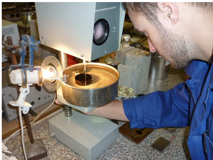
Obr. 24: Nastavení jehly těsně nad povrch asfaltového pojiva
