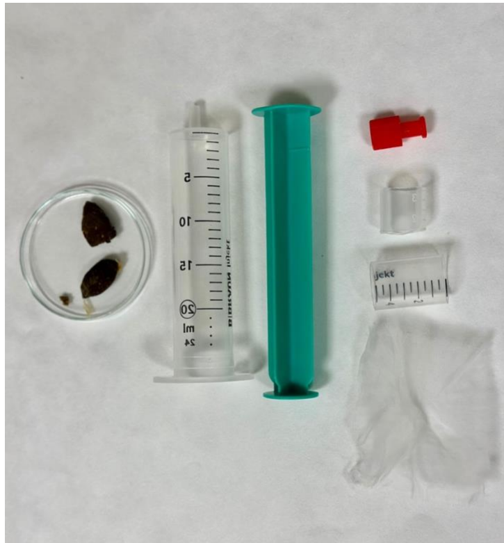
Obrázek 3 Zleva: Petriho miska s výkaly infikovaných jedinců Rattus norvegicus (Berkenhout, 1769) plastová odstředivá stříkačka, červená výpust, plastové části, které pomáhají při proudění aktivních larev a uhelon s velikostí ok 128 \mu\text{m} . (MSc. Divakaran Pandian, BSc. 2024).
