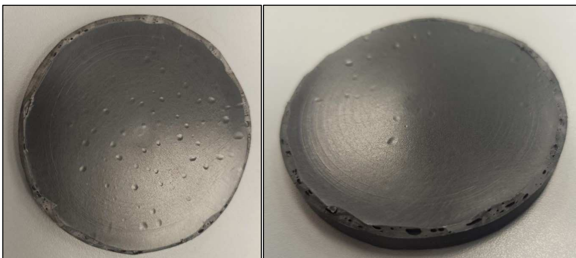
Obrázek 29: Propadlé bublinky na A ploše a v řezu na hraně vzorků
