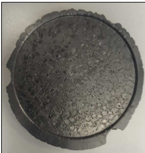
Obrázek 28: Neopracovaný přetok na zmetkovém vzorku
