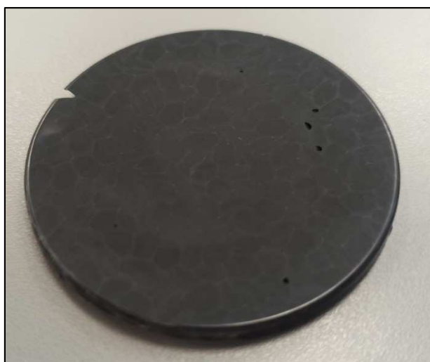
Obrázek 23: Viditelné okraje jednotlivých granulí
