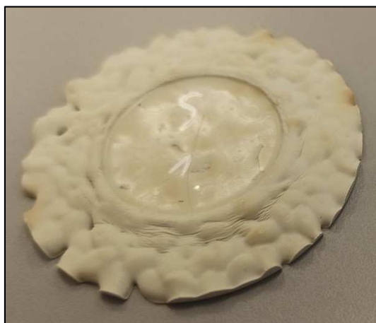
Obrázek 21: Degradace materiálu působením přílišného tepla
