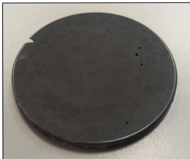
Obrázek 23: Viditelné okraje jednotlivých granulí
