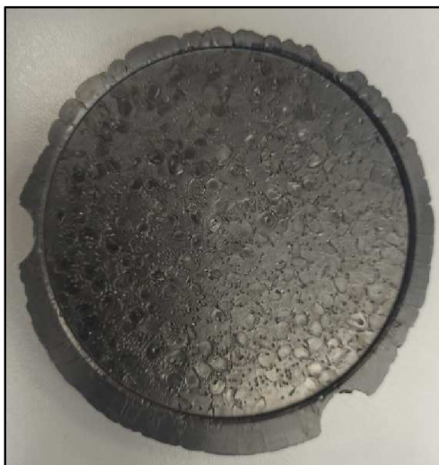
Obrázek 28: Neopracovaný přetok na zmetkovém vzorku
