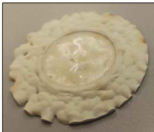
Obrázek 21: Degradace materiálu působením přílišného tepla
