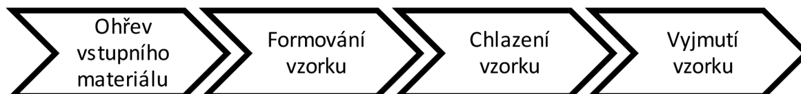
Obrázek 18: Základní struktura procesu tepelného tváření
