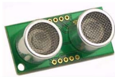
Obrázek 3.1.5: Ultrazvukový senzor SRF05
