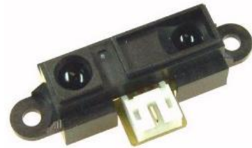
Obrázek 3.1.3: Infračervený senzor SHARP GP2Y0A21
