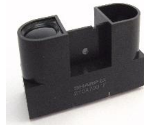
Obrázek 3.1.4: Infračervený senzor SHARP GP2Y0A70
