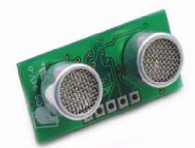
Obrázek 3.1.6: Ultrazvukový senzor SRF10
