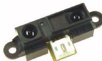
Obrázek 3.1.3: Infračervený senzor SHARP GP2Y0A21
