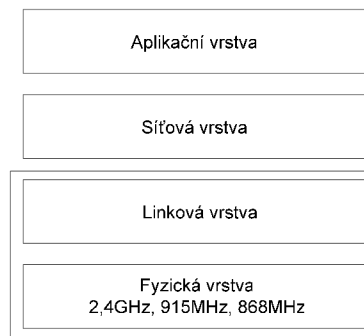
Obrázek 2.5.1: Model komunikačního protokolu ZigBee (zjednodušený model)
