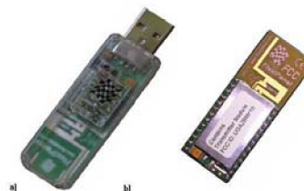
Obrázek 2.5.5: Moduly ZigBee Pixie
