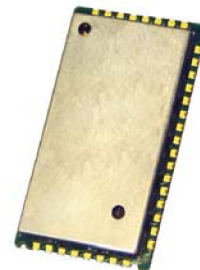
Obrázek 2.1.3: VF modul Tiny One
