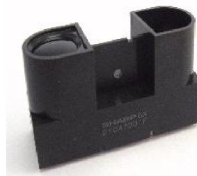
Obrázek 3.1.4: Infračervený senzor SHARP GP2Y0A70
