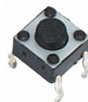
Obrázek 3.3.1: Mikrospínač s páčkou Obrázek 3.3.2: Mikrospínač – tlačítko
