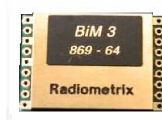
Obrázek 2.1.2: VF modul BiM3
