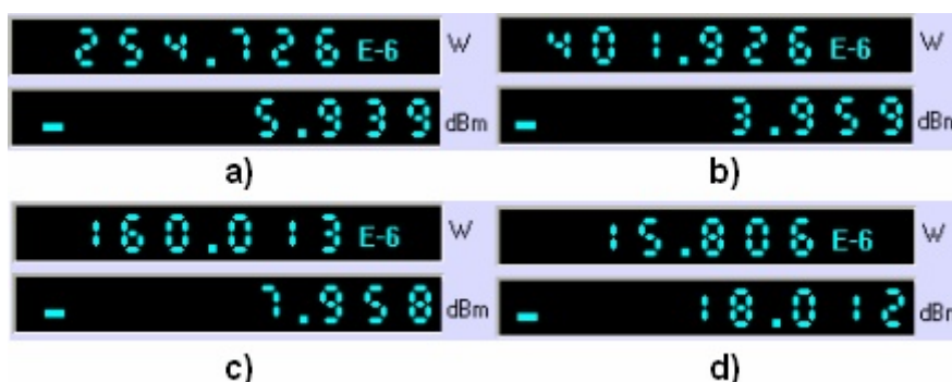
Obr. 7.16: Výkonové úrovně optického signálu ve směru OLT -> ONT: a) na vstupu AWG (PM2), b) na výstupu AWG (PM3), c) za vláknem (PM5), d) na vstupu ONT (PM7).
