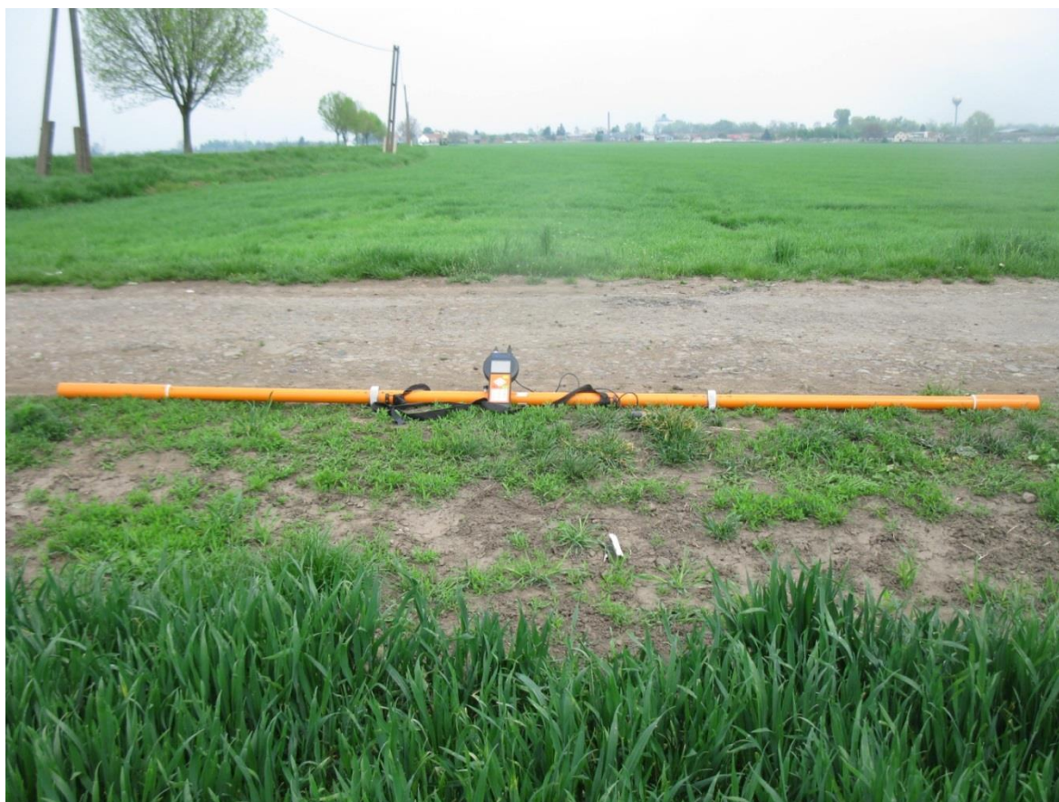
Obr. 15: Konduktometr s řídicí jednotkou, foto Bílá
