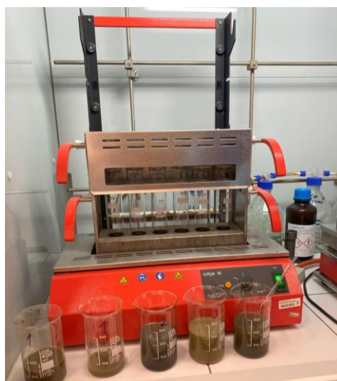
Obr. 5.9 InKjel M ručně nastavitelný infračervený trávící systém
