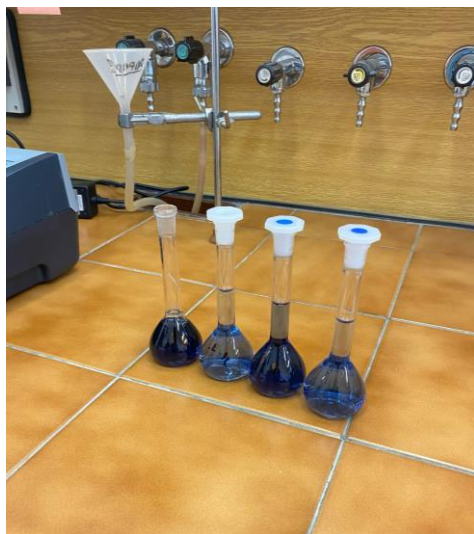
Obr. 5.5 Nachystané vzorky pro měření P_c pomocí spektrofotometru
