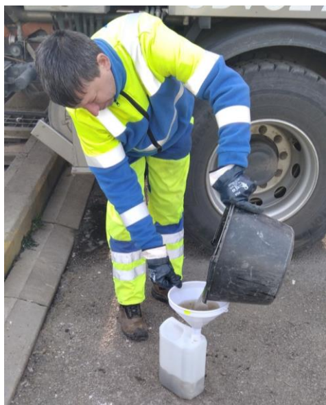
Obr. 5.1 Slévání vzorků septických vod na ČOV Boskovice
