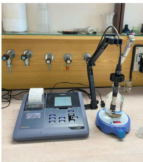
Obr. 5.11 Měření BSK_5 pomocí sondy
