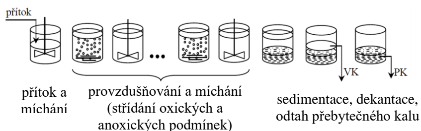
Obr. 5.21 Fáze SBR reaktoru [16]
