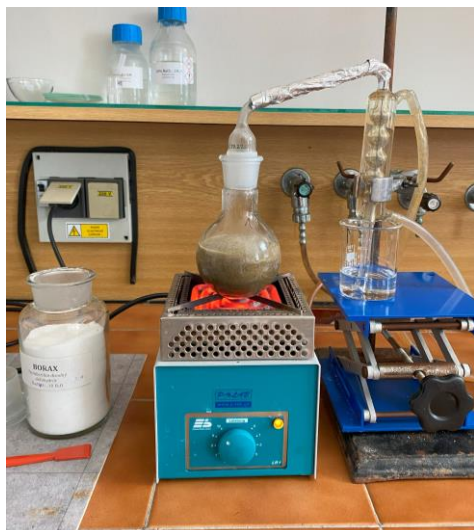
Obr. 5.7 Destilace vzorku pro určení N-NH 4
