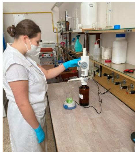
Obr. 5.8 Titrace vzorku pro určení N-NH 4
