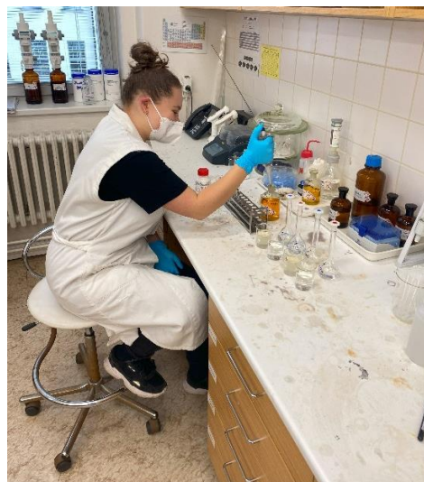
Obr. 5.6 Příprava vzorků pro měření CHSK_{Cr}
