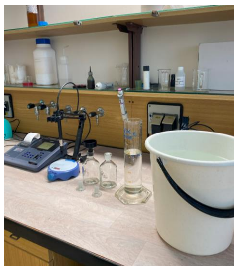
Obr. 5.12 Chystání vzorků pro měření BSK_5
