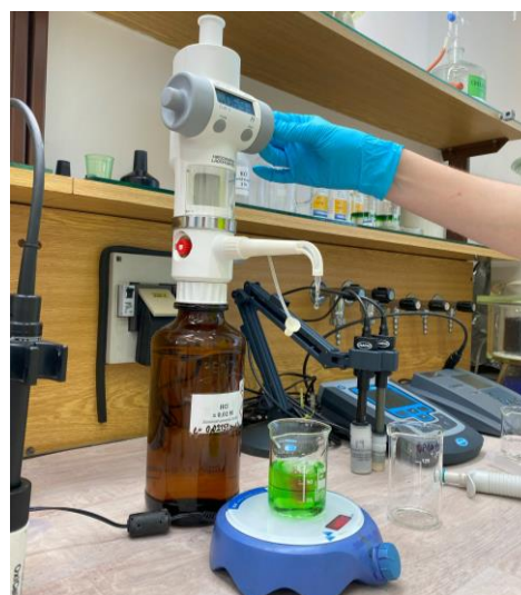
Obr. 5.10 Titrace vzorku pro určení N KJ
