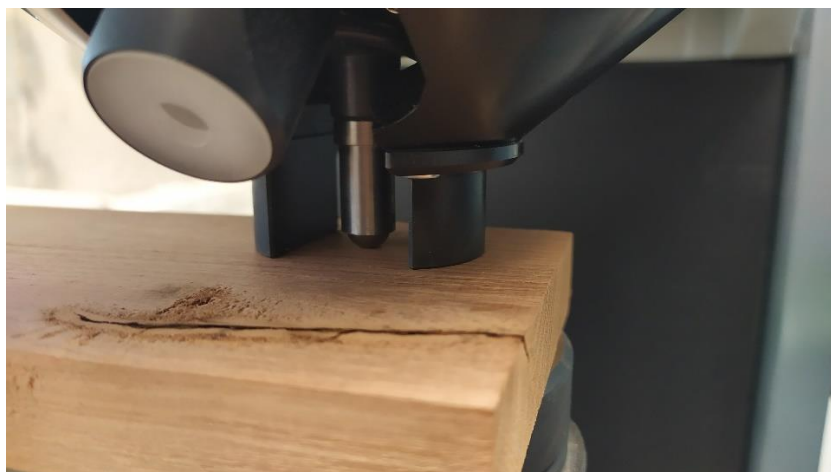
Obr. 28 Detail upnutí vzorku do tvrdoměru DuraVision-30 (zdroj: autor)
