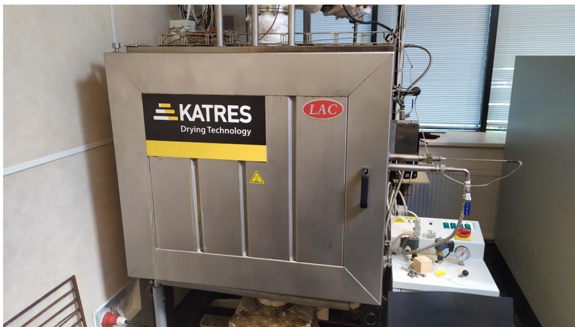
Obr. 19 Termokomora Katres, kde se uskutečnila výroba zkušebních vzorků (zdroj: vlastní)
