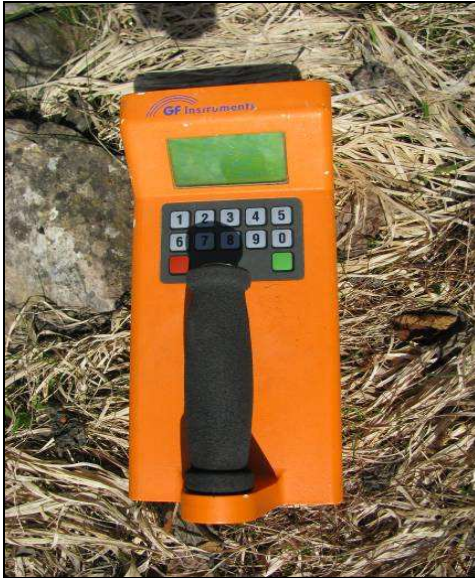
Obr. 1: Terénní gamaspektrometr GRM-260 při měření na plochem výchozu.
