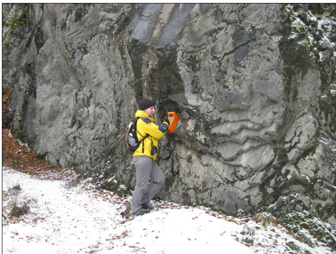
Obr. 26. Gamaspektrometrické měření na lomové stěně na lokalitě Špláz v Javoříčském krasu.
